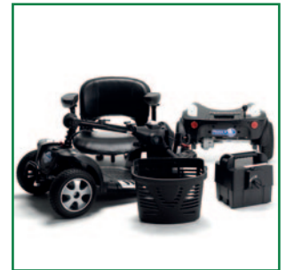
Desmontable en 5 partes sin herramientas adicionales
