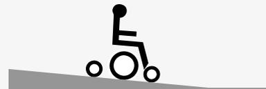
El centro de gravedad de la silla de ruedas cambia cuando se cambia la posición del asiento y/o del respaldo. Cuando levante o incline el asiento o el respaldo, disminuirá la estabilidad de la silla de ruedas.
