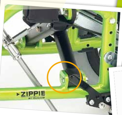
Con la misma cruceta se puede ajustar la anchura de la silla hasta en 5 cm.
