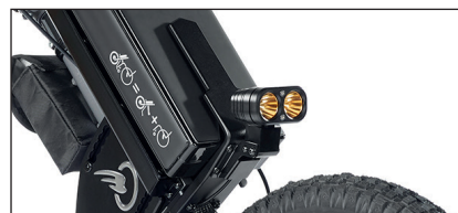
Doble luz delantera de 2000 lúmenes. Luces de posición y luces largas. Faros con lente en tono amarillo de inspiración retro.
