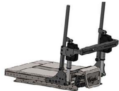
Respaldo reclinable eléctrico 0° a 160°
