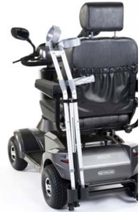
22219095 Soporte de bastones montado en el parachoques trasero
