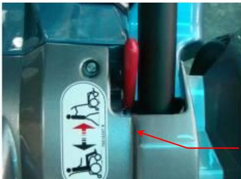
Palanca de rodada libre/ la fuerza máxima requerida de la mano-brazo en la palanca será de 19 N para conectar y de 35 N para desconectar
