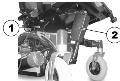
La imagen anterior muestra la posición de las placas de ajuste perforadas (1) y del pistón (2) que permiten el ajuste de la inclinación y la altura del asiento.
