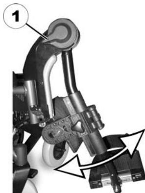
1. Apriete hacia abajo la palanca desbloqueadora (1). Ajuste el reposapiés al ángulo deseado.
