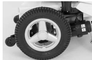
1. Gire el tornillo de acoplamiento hacia la izquierda. El motor se acoplará.
