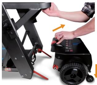
1. Tire hacia arriba del ajuste del eje trasero hasta que la rueda auxiliar toque el suelo.
