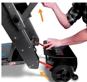
2. Levante el asiento y acople las dos guías de posición en el manguito de enganche del eje trasero.
