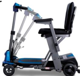
Presione la palanca del manillar extensible para ajustar el manillar al ángulo adecuado y, a continuación, suéltela.
