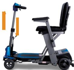
Presione el elevador del manillar para ajustar la altura y la posición del manillar y, a continuación, suéltelo.
