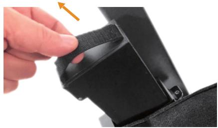
Tire de la correa de la batería para extraerla fácilmente. Para instalarla de nuevo, introdúzcala en la ranura. ¡Hecho!
