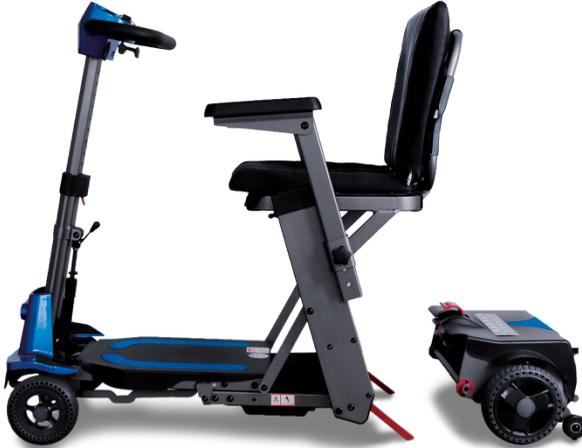
2. Función de plegado automático con mando a distancia y bluetooth. Su plegado automático en segundos permite transportar el scooter sin esfuerzo.
