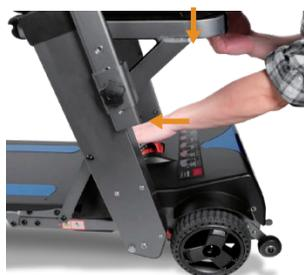
4. Presione hacia abajo el ajuste del eje trasero y baje el asiento.
