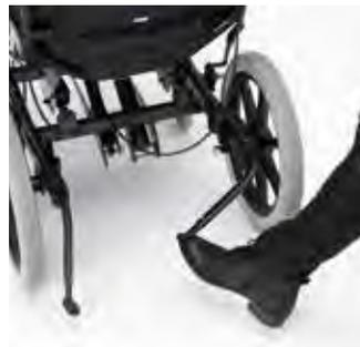
El dispositivo antivuelco se puede abatir fácilmente con el pie para no estorbar al acompañante.
