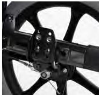
Posición de rueda trasera ajustable (9 cm) para incrementar la maniobrabilidad o la estabilidad de la silla.
