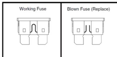
Figura 64 Identificación del estado del fusible
