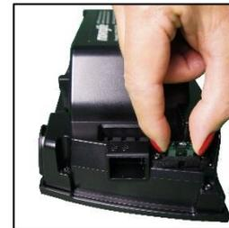
Figura 65 Sustitución de un fusible fundido
