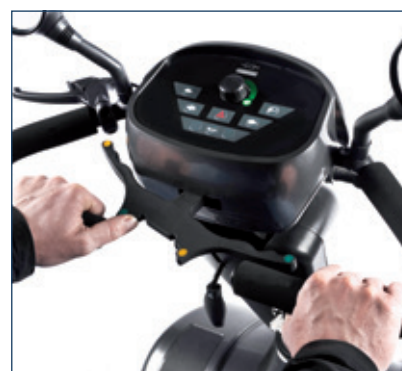
Panel de control táctil y waterproof que ofrece un ajuste sencillo de la velocidad, indicador de batería de LED y bocina.
