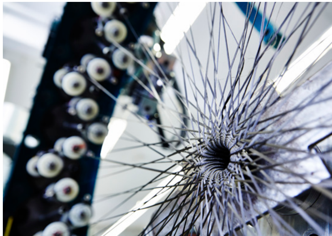
Proceso de trenzado de los filamentos de carbono realizado por robots para confeccionar los tubos de armazón de la Krypton.
