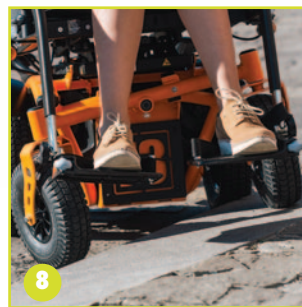
Eje basculante delantero para terrenos irregulares
