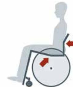
El diseño del asiento ergonómico con su sección en cuña y su sección horizontal optimiza la estabilidad pélvica, facilita la propulsión de la silla y minimiza la fricción para proteger la piel.
