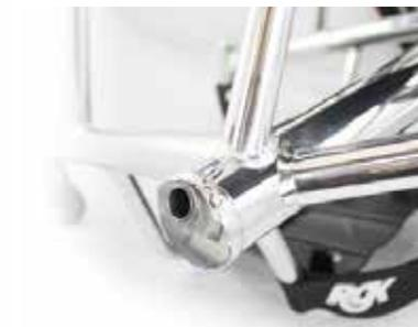
Tubo del eje integrado para máxima rigidez en el juego.
